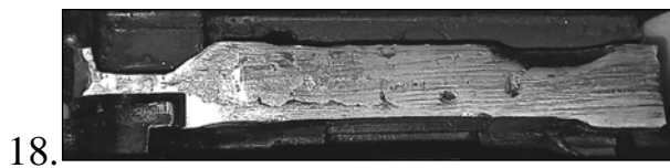
Зображення 18. Сліди напливу металу та механічної обробки на гребні затвору переробленого пістолету.
