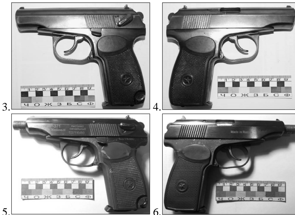
Зображення 3-6. Самозарядні пістолети, виготовлені шляхом переробки саморобним способом сигнальних пістолетів «МР-371» (із видаленими маркувальними позначеннями (зобр. 3, 4) та з наявними маркувальними позначеннями (зобр. 5, 6), які перероблені для стрільби 9-мм патронами до пістолету Макарова (ПМ) (вид з двох боків).
