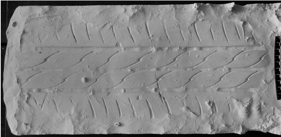
Рис. 2. Гіпсовий зліпок сліду протектора шини виготовлений на субстанції багаторазового використання «MikroTrack™».
