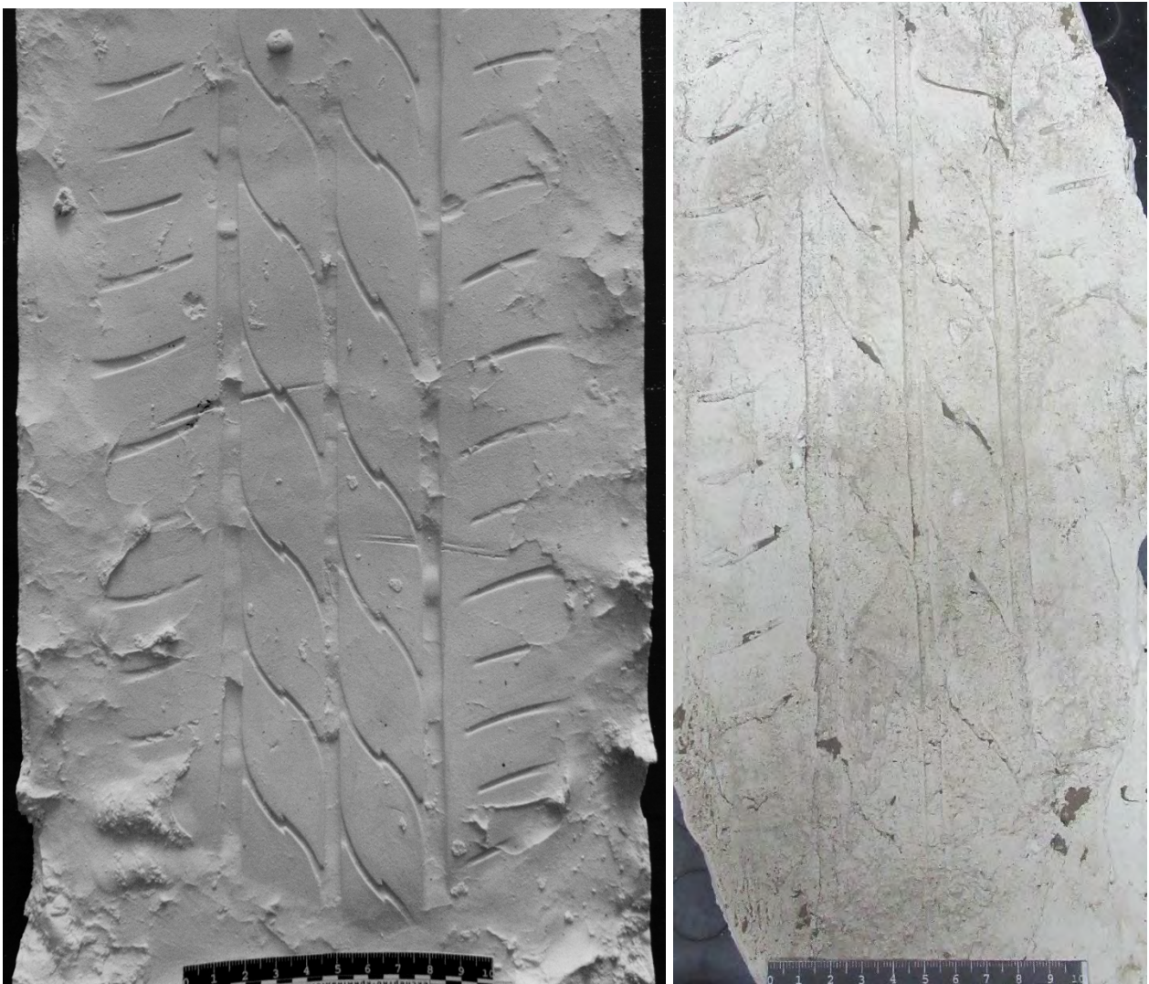
Рис. 5, 6. Збільшене зображення зліпку, виготовленого зі сліду, що залишений на субстанції «MikroTrack™» (зліва) та зліпку, виготовленого зі сліду, що залишений на ґрунті (зправа).
