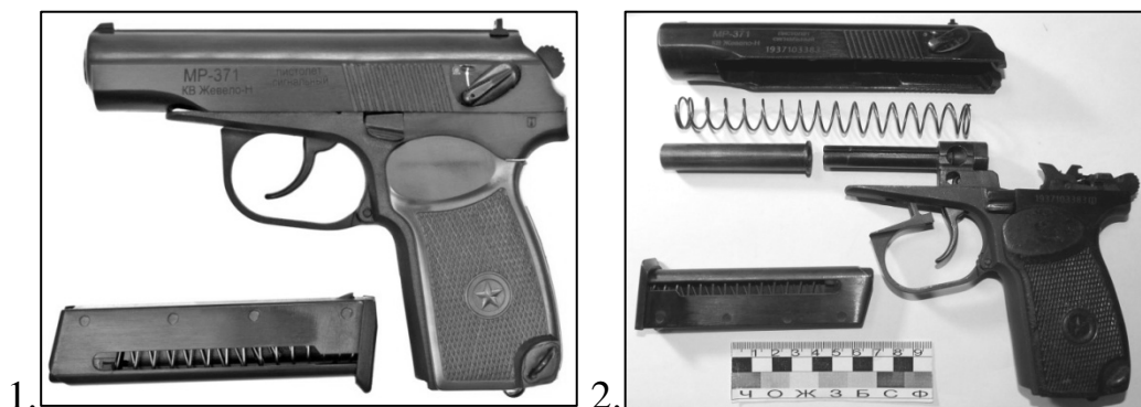
Зображення 1, 2. Загальний вид сигнального пістолету моделі «МР-371» (зобр. 1) та вид його частин і деталей при неповному розбиранні (зобр. 2).
